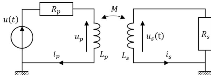
Cette situation représente en réalité un transformateur, où les pertes par effet Joule ne sont pas négligées. Le circuit primaire (à gauche sur le schéma) est alimenté par un générateur idéal de tension d'amplitude  $u(t) = E \cos(\omega t)$ . Le circuit secondaire (à droite sur le schéma) alimente un dipôle de résistance  $R_s$ . Avec les conventions représentées sur le schéma pour les intensités  $i_p$  et  $i_s$ , le coefficient  $M$  est positif.
