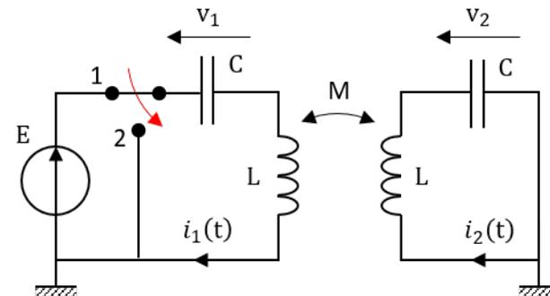
En  $t = 0^-$ , le système a atteint un régime stationnaire. À  $t = 0$ , on bascule l'interrupteur dans la position 2.
